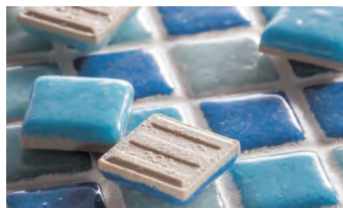
ガラスと磁器質タイルの二層構造・裏足付き・角丸形状
